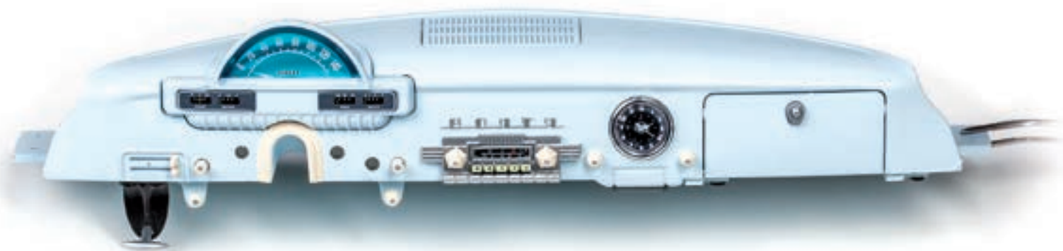
Панель приборов с установленной пепельницей и ручкой привода центрального тормоза
